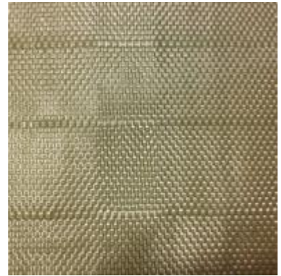
(d) Plain fabric with double-pick insertion
